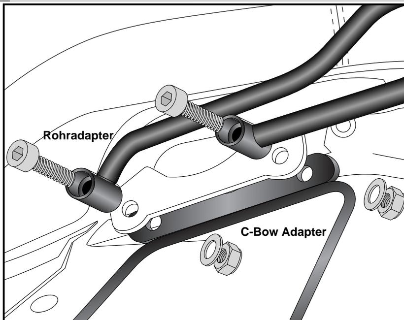
**HINWEIS:** an den zusätzlichen freien Bohrungen kann der Lock it Hecktaschenhalter verschraubt werden, siehe Bild.
