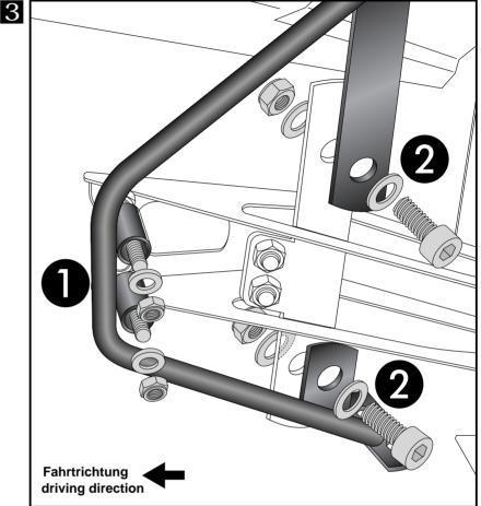
Montage C-Bow Halter vorne links/rechts: Die Originalschrauben der Soziusfußrastenhalterung entfernen, diese entfallen. Die Halter zwischen Fußraste und Rahmen mit den Zylinderschrauben M8x40 und U-Scheiben Ø8,4 verschrauben. Zwischen Halter und Rahmen die Aludistanz Ø25xØ9x5mm fügen.
