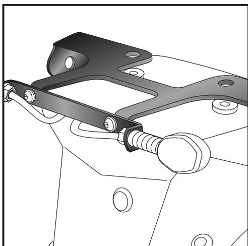
**5** Die in Montageschritt 3 zusammengebaute Kombination aus Blinkerhaltebügel und Halteadapter wird auf die Heckverkleidung gelegt, die Blinkerkabel oberhalb der Schlußleuchte und Heckverkleidung durchgeführt und innen hinter der Leuchte angeschlossen. Zentralstecker Beleuchtung wieder zusammenstecken und den Zug der Sitzbankverriegelung wieder einhängen.
