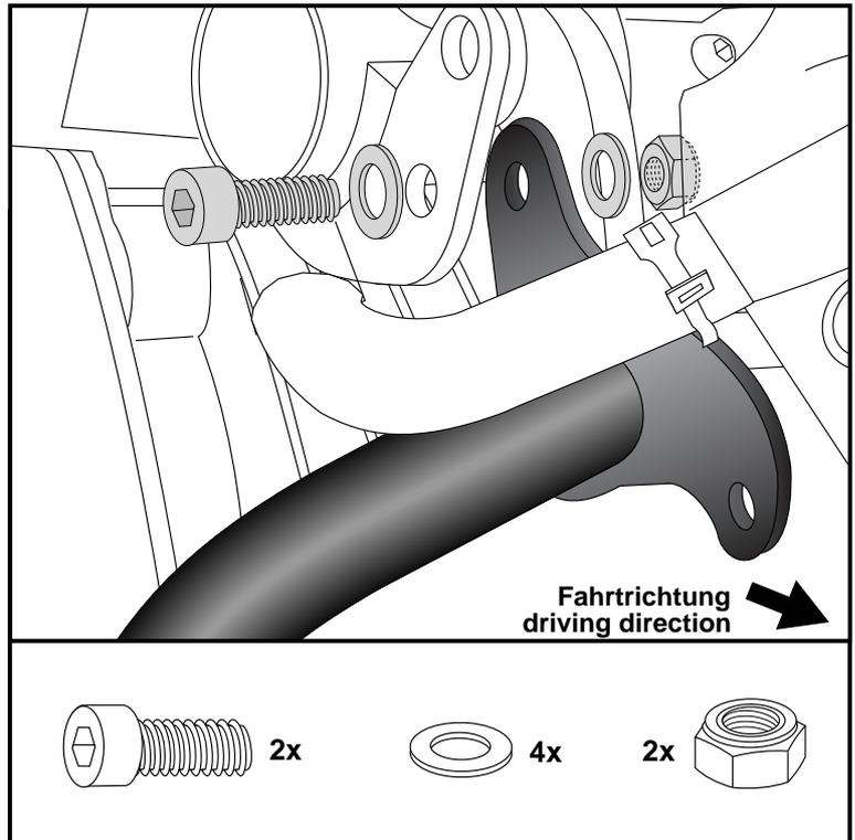
Montage des Motorschutzbügels vorne
