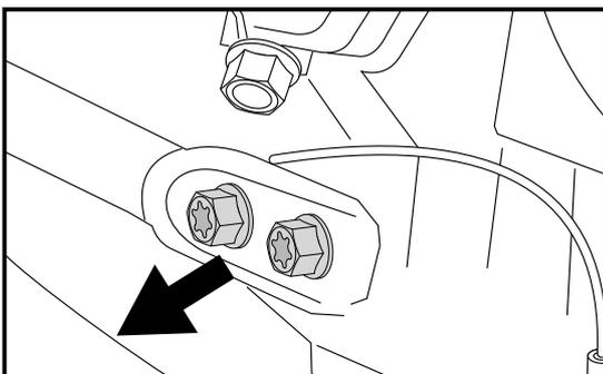
Vor Montage der jeweiligen Seite müssen die beiden Schrauben der unteren Rahmenbefestigung entfernt werden, diese entfallen.
